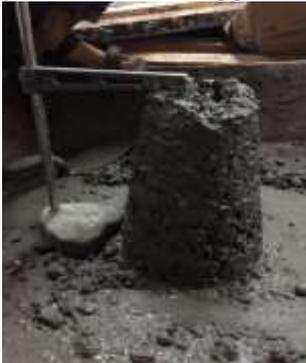
Gambar 4.1 Pengujian *Slump*
